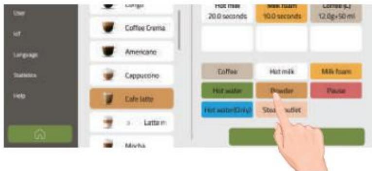
**Tvorba nového nápoje:** Po stisku tlačítka Přidat v menu nastavení nápojů je možné přidávat a upravovat kroky, ze kterých bude nový nápoj složen. Krok lze přidat stiskem jeho ikony na spodní straně obrazovky. Nápoj může být složen až ze 6 kroků. Nastavitelnost jednotlivých kroků je popsána níže v kapitole „Přehled parametrů receptu“.
