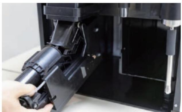
Stiskněte jistící tlačítko pod spařovací jednotkou pro její uvolnění
