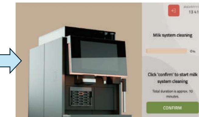
Potvrďte spuštění čistícího úkonu stiskem tlačítka Potvrdit (Confirm). Na obrazovce se zobrazí další pokyny. Následujte pokyny na obrazovce pro dokončení čištění.
