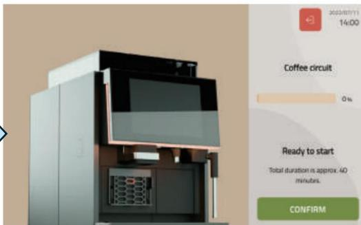
Potvrďte spuštění dekalcifikace stiskem tlačítka Potvrdit (Confirm). Na obrazovce se zobrazí další pokyny. Následujte pokyny na obrazovce pro dokončení čištění.
