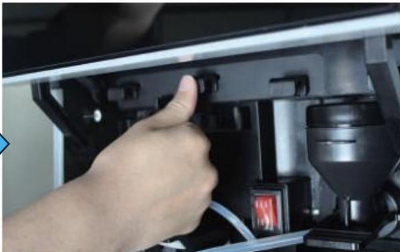
Posuňte páčkou zpět do původní pozice pro opětovné uzamčení zásobníku.
